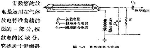
图 1-2 計数管基本电路
